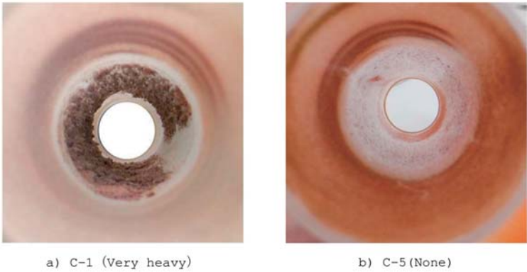
図2 フリーボード内壁の灰付着状況 Fig.2 Inside wall of the freeboard
