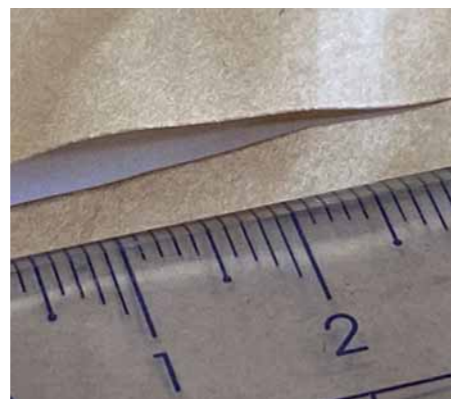
図6 超音波振動を使用した場合の切断面 Fig.6 Cutting surface with the use of ultrasonic vibration
