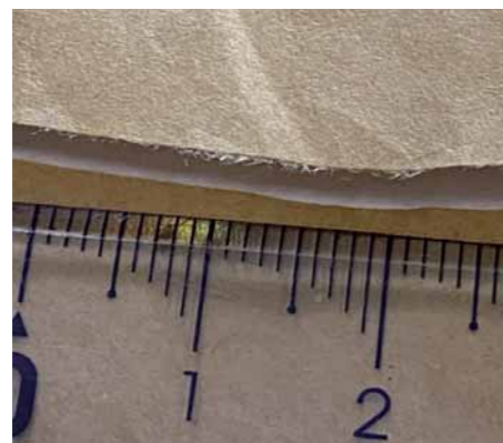
図5 超音波振動を使用しない場合の切断面 Fig.5 Cutting surface without the use of ultrasonic vibration
