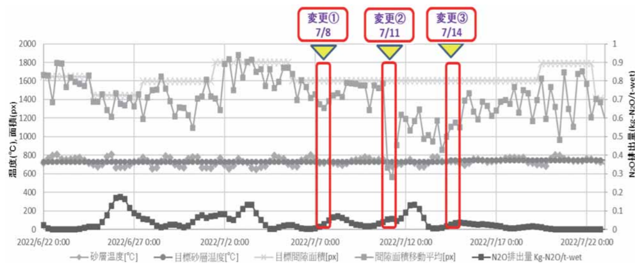
図9 30日間連続運転のトレンドと制御パラメータ変更タイミング Fig.9 Trend of 30-day continuous operation and control parameter change timing
