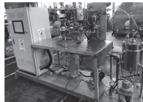
図3 BoCross® フィルタ小型試験機(0.013m<sup>2</sup>)
