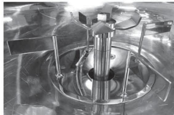
図7 改良版ミキシレータ®混合羽根と邪魔板
