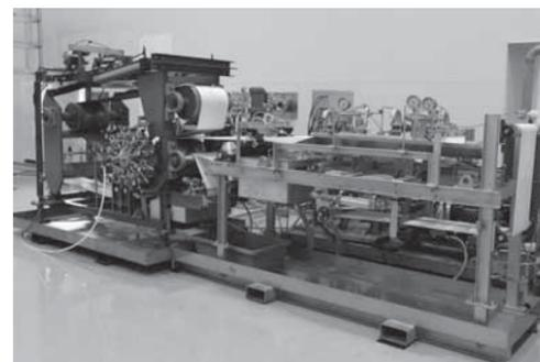
図2 水平ベルトフィルタおよび圧搾ブロー脱水機小型試験機(0.1m<sup>2</sup>)
