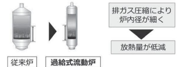
図6 過給式流動焼却炉の放熱低減
