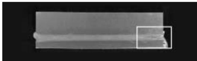
図4 131mm厚アルミニウム合金 EBW溶接部(30kW機)
