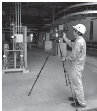
図2 レーザースキャナの計測状況 Fig.2 Measurement status of laser scanner
