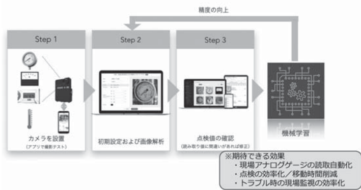
図2 IoTカメラによる現場アナログゲージの読取イメージ *2 Fig.2 Image of IoT camera for field analogue gauge reading *2
