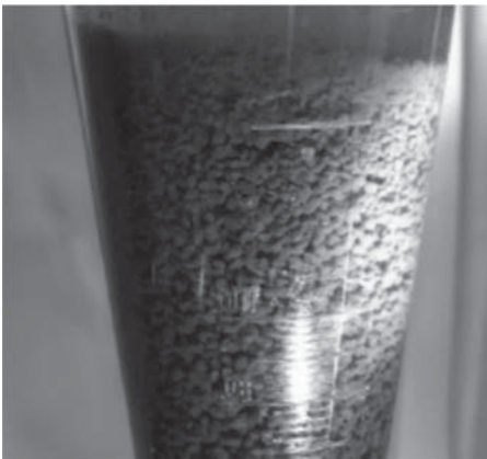
図3 試験に使用したグラニュール Fig.3 Granules extracted from reactor.
