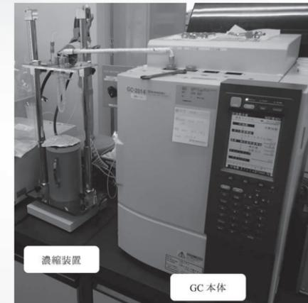
図1 消化ガス分析用ガスクロマトグラフィー
