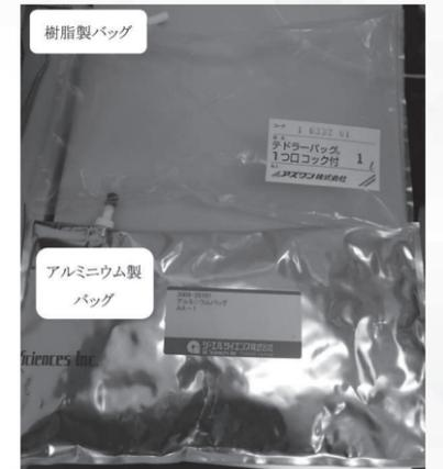
図2 消化ガスサンプリング用バッグ(上：樹脂製、下：アルミニウム製)
