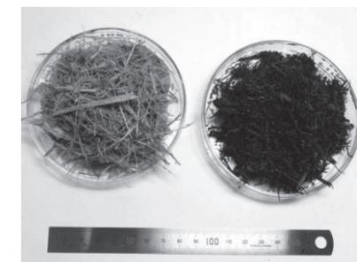
図4 クラッシング開始直前(右)と直後(左)のバガスの写真
