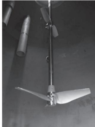
図3 インペラ式攪拌機 Fig.3 Impeller agitator
