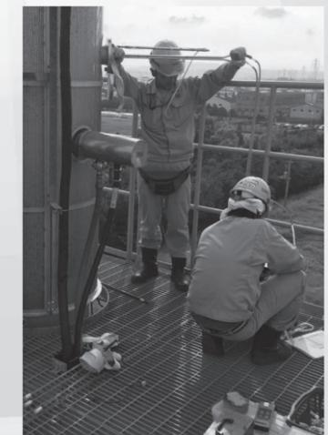
図4 排ガスサンプリングの様子
