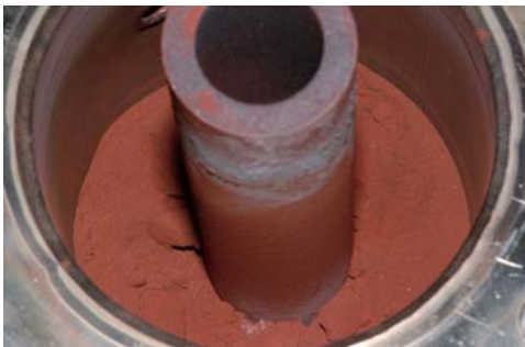
図7 セラミックフィルターで回収されたフライアッシュ Fig.7 Photograph of fly ash separated by ceramic filter module attached with the lab-scale fluidized bed combustor.
