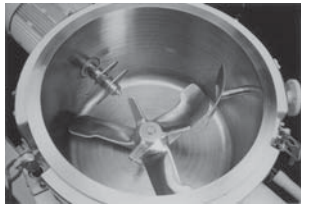
図1 ユニバーサルミキサ混合槽内部、3枚羽根のアジテータと槽壁のチョップパ Fig.1 Inner view of Universal mixer, 3-blades agitator and chopper on side wall
