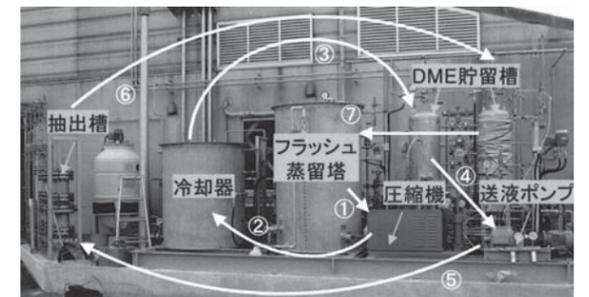
図4 DME常温脱水浄化プロセス試作機(矢印と数字はDMEの循環ルート)
