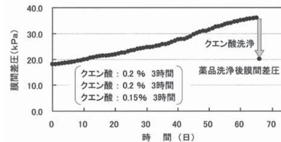
図25 Run2における膜間差圧の変化
