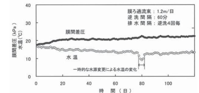
図31 粒状活性炭カートリッジ設置における膜間差圧の変化
