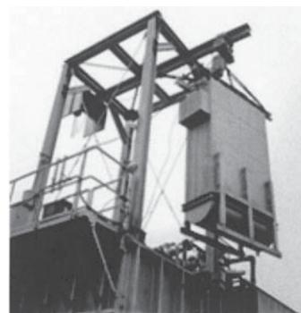
図7 膜ユニット吊上げ状態
