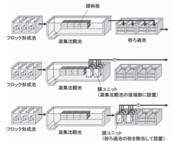
図2 既設躯体への膜ユニットの設置イメージ
