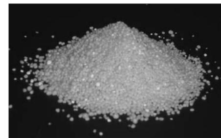
図4 下水処理におけるリン資材回収の一例
