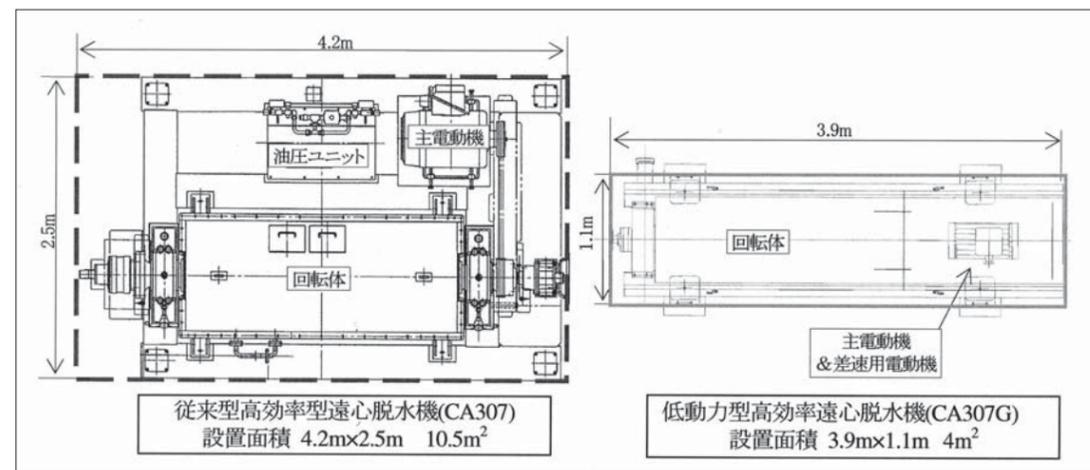
図6 標準処理量15m<sup>3</sup>/h機での比較
