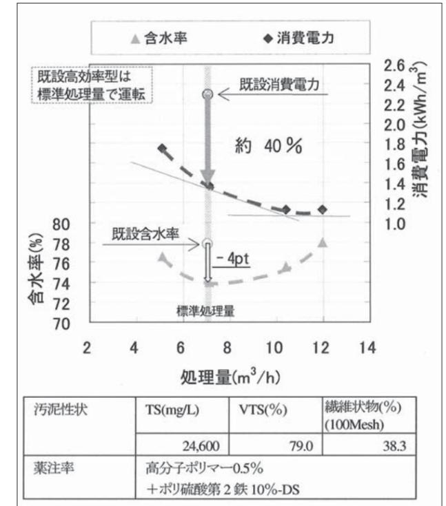
図7 運転事例(A処理場:混合生汚泥)
