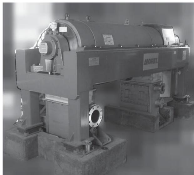
図1 低動力型高効率遠心脱水機外観
