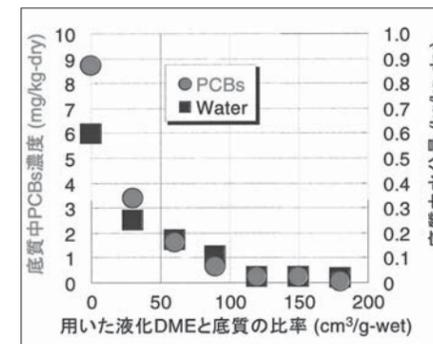
図11 液化DMEによるPCBs汚染底質からのPCBsと水分の抽出特性
