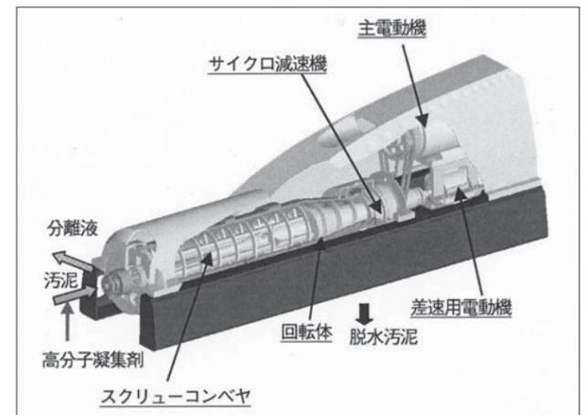
図2 低動力型高効率遠心脱水機(CA-G型)の基本構造
