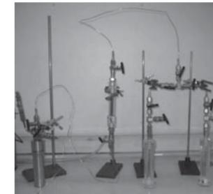
図9 PCBs汚染底質・常温脱水浄化試験装置
