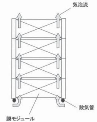
図19 膜モジュール端部の曝気
