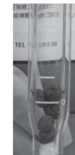
図10 PCBs汚染底質充填カラム
