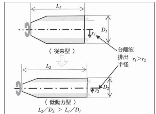
図4 低動力化の原理
