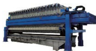
汚泥脱水機 (浄水場)
