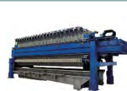
汚泥脱水機 (浄水)
